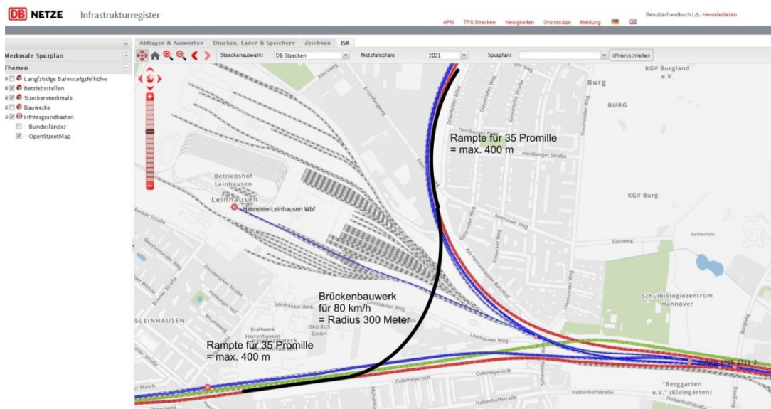
Abb. 2.9: Lage, Ausdehnung und technische Parameter einer Verbindungskurve am ehemaligen Güterbahnhof Herrenhausen. Eigene Berechnung auf der Grundlage von Kartenmaterial der DB und von Luftbildern. Die kurzen Rampen sind hier möglich, wenn die Nutzung den wenigen ICE-Zügen vorbehalten bleiben sollen (Maximalsteigung für Hochgeschwindigkeitszüge nach EU-Verordnung).
